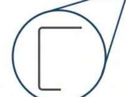
FG0204D PERFIL TRASEIRO 2430mm REFORÇADO (esp. 6,35mm)
